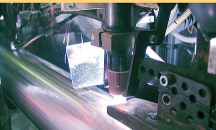
Die Längsnaht wird per Laser-, Plasma- oder WIG-Schweißprozess geschweißt
