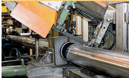
Herstellungslängen von 6 m bis 18 m sind möglich, ebenso Fixlängen
