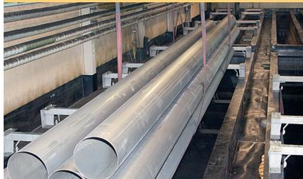
Bei BUTTING werden alle Rohre im Vollbad gebeizt – das Ergebnis ist die Passivschicht zum Korrosionsschutz
