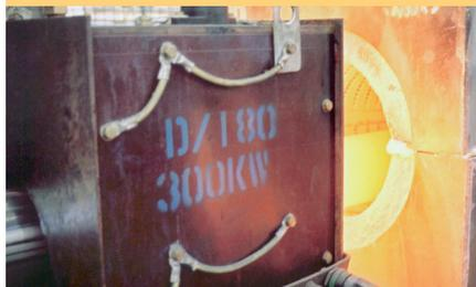
Die Wärmebehandlung erfolgt online – in einem induktiven Lösungsglühprozess
