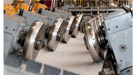
Mittels Profilerollen wird das Coil zum Schlitzrohr eingeformt
