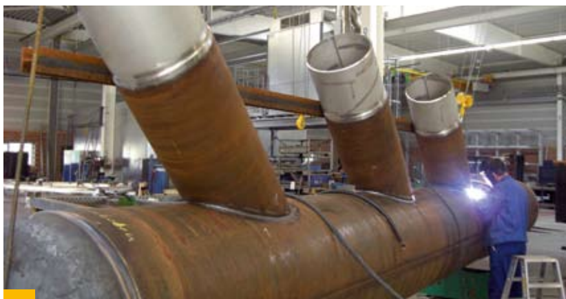
Nossa competência: O processamento técnico de soldagem adequado ao material de aços inoxidáveis e cladeados
