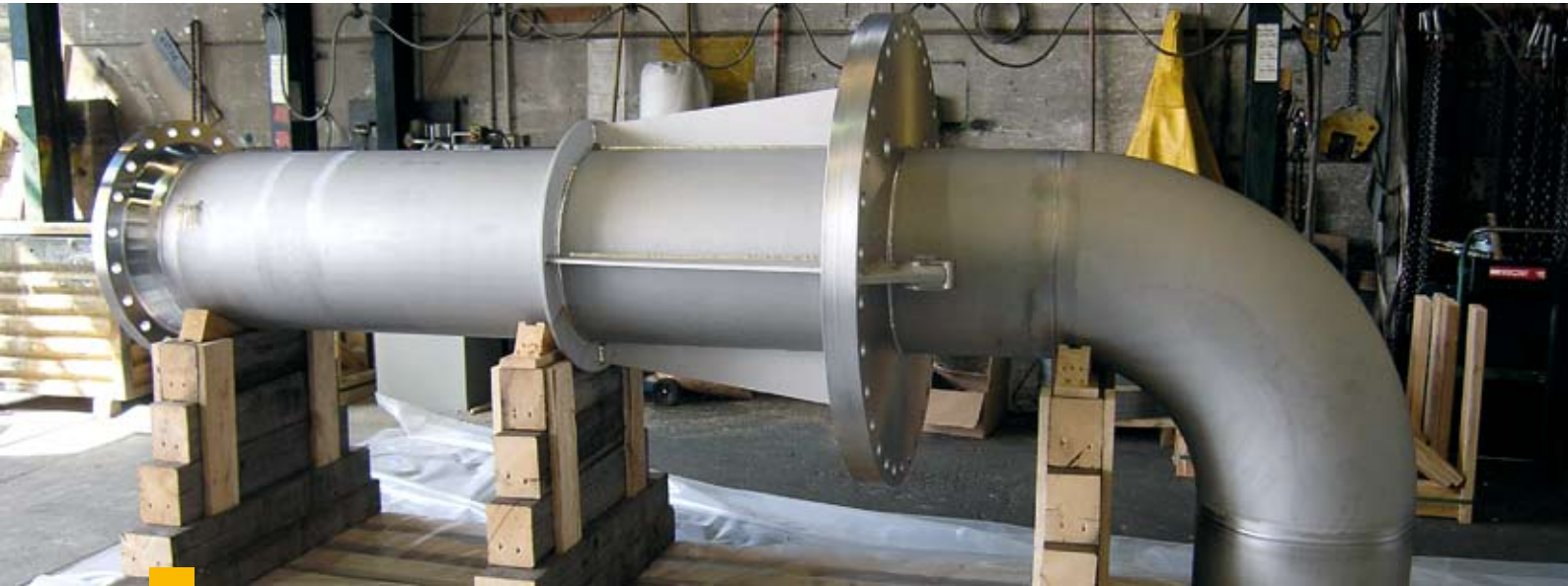
Sistemas de tubos pré-fabricados para a engenharia de perfuração e construção de poços em duplex prontos para o embarque
