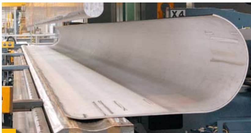
Fabricação de tubos através da deformação de chapas de aço
