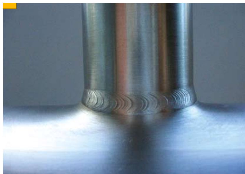
Bild 17: Orbitalschweißnaht mit ausgezeichneter Schweißnahtgüte
