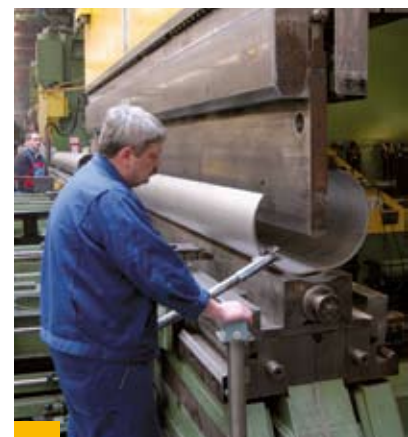
Bild 10: Produktion eines Rohres durch Einförmung einer Blechtafel
