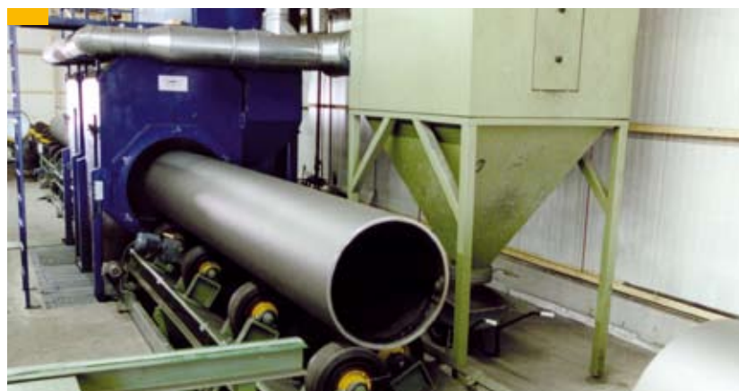
Bild 28: Die Außenstrahlanlage von BUTTING für die Oberflächenbehandlung von Rohren
