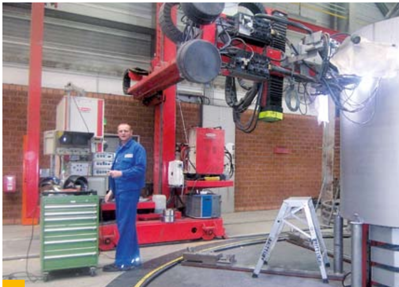
Bild 18: MAG-Schweißen mit flexiblem Schweißautomaten
