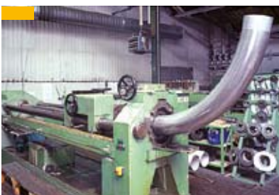
Bild 8: Rohrbogen, im Walzverfahren gefertigt
