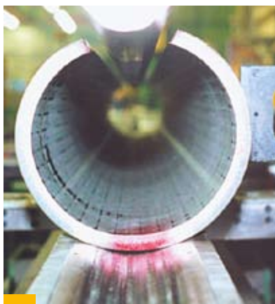
Bild 2: Einförmung einer Blechtafel zu einem Rohr
