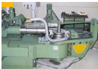
Bild 9: Rohrbogen, im Dornbiegeverfahren nach Isometrievorgabe gefertigt
