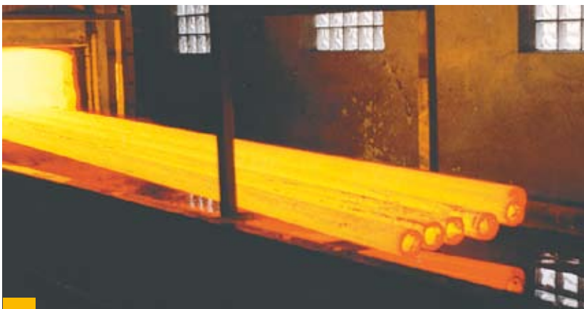
Bild 20: 6 Meter lange Rohre werden nach dem Glühen im Wasserbad abgeschreckt
