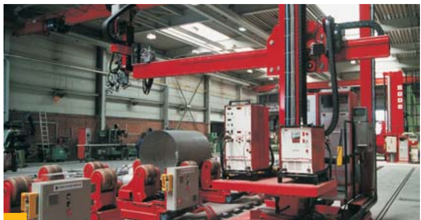
Poziome urządzenie spawalnicze do szwów obwodowych przemieszczające się równoległe do ciągu produkcyjnego w położeniu wzdłuż
